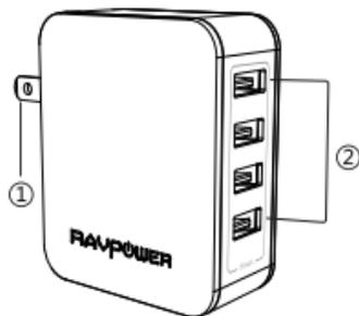
① 電源ソケット ② iSmart USB 充電ポート (各ポート最大DC 5V/2.4A)
